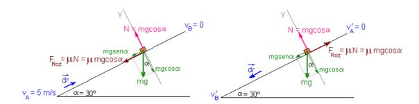
Las fuerzas, en el sistema de referencia de la figura serían, en newton:
