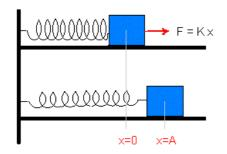
Al soltar el muelle éste ejecutará un movimiento vibratorio armónico simple (MAS). Al máximo desplazamiento de la posición de equilibrio lo llamaremos Amplitud (A=8cm)
