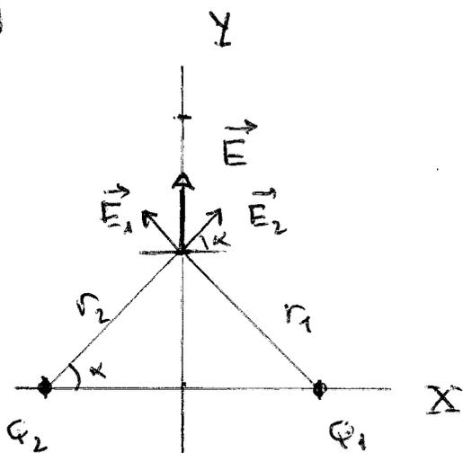
Para que  $\vec{E}$  esté dirigido en el sentido positivo del eje Y,  $\vec{E}_1$  y  $\vec{E}_2$  tienen que ser como se indica en la figura.
