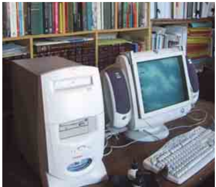
La cubierta metálica de una C.P.U. (unidad central de procesos) actúa como jaula de Faraday.
