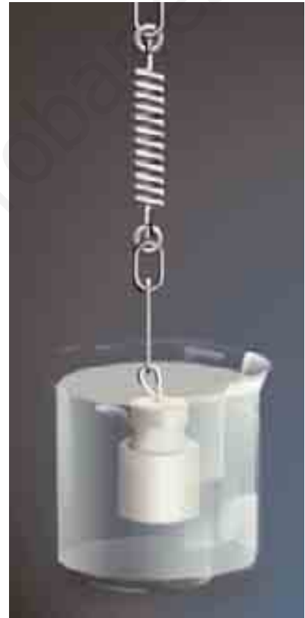
En un circuito RLC las oscilaciones se amortiguan, tal como sucede en un sistema masa-resorte oscilando al interior de un vaso con líquido.
