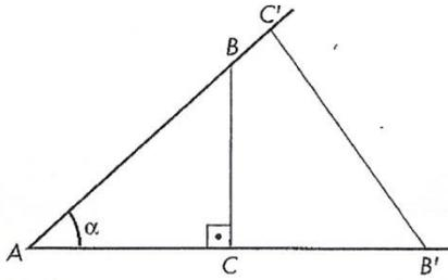
Si sobre un ángulo,  $\alpha$ , se construyen dos triángulos rectángulos distintos,  $ABC$  y  $AB'C'$ , se obtienen dos valores para  $\text{sen}\alpha$ :
