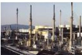
El petróleo bruto obtenido, un líquido espeso y de color negruzco, se somete a un proceso de refinado para separar los diversos hidrocarburos que lo forman. Este proceso se lleva a cabo en las **refinerías** y consiste en una **destilación fraccionada**, que separa en forma de vapor los distintos componentes del petróleo según su temperatura de ebullición.
