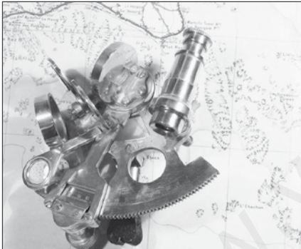
SEXTANTE: instrumento para medir ángulos.
