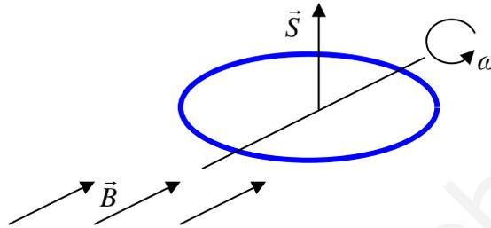
ii) Si el campo magnético es perpendicular al eje de rotación, es decir, al diámetro sobre el que gira la espira, se induce en esta una fuerza electromotriz ya que el flujo magnético que la atraviesa varía, siendo máximo cuando la espira está en el plano horizontal y cero si está en el plano vertical, como se ve en el siguiente esquema
