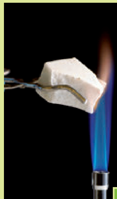
En la calcinación del mármol (carbonato de calcio, \text{CaCO}_3 ) se obtienen vapores de dióxido de carbono ( \text{CO}_2 ).
