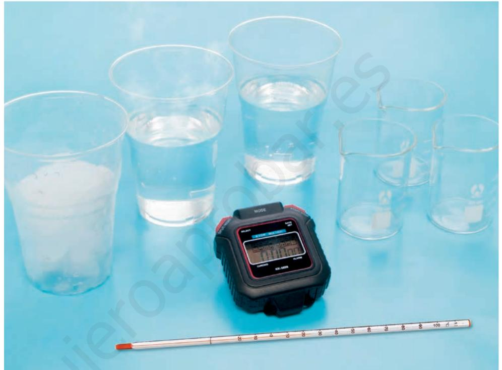
Debemos usar un termómetro de alcohol. Hay algunos que contienen mercurio y son muy peligrosos si se rompen. Asegúrate que el que uses sea de alcohol.
