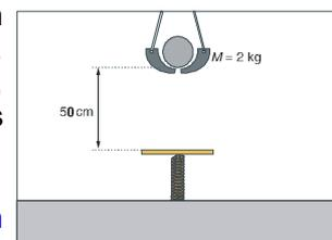
La energía potencial gravitatoria de la masa que cae se convierte en energía potencial elástica al comprimirse el muelle.
