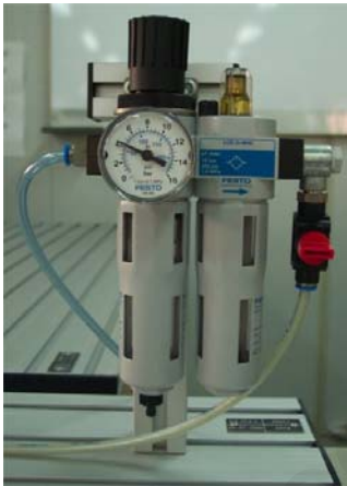
Foto de la unidad de mantenimiento
