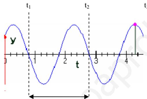
De la gráfica podemos ver que, para dos instantes  $t_1$  y  $t_2$ , separados por un intervalo de tiempo igual a un período, el punto vuelve a alcanzar el mismo estado de vibración. Sin realizar desarrollos trigonométricos, lo anterior equivale, matemáticamente, a:
