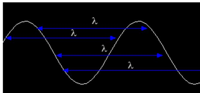
La representación de la función  $y$  frente a  $x$  es como la foto instantánea de una cuerda vibrando. Las posiciones de la cuerda en determinado instante se reflejan en la siguiente gráfica:
