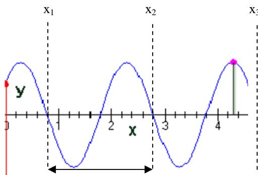
De la gráfica podemos ver que, para dos puntos  $x_1$  y  $x_2$  (y para un mismo tiempo), separados por una distancia igual a una longitud de onda, se vuelve a alcanzar el mismo estado de vibración. Sin realizar desarrollos trigonométricos, lo anterior equivale, matemáticamente, a:
