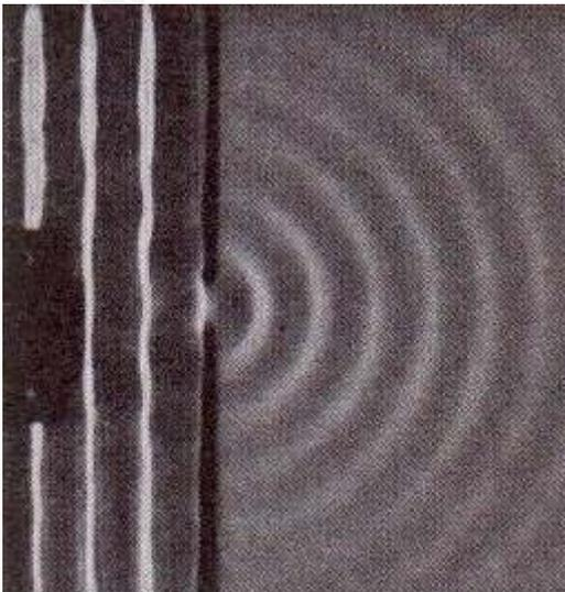
ondas elementales secundarias, de igual velocidad y frecuencia que la onda inicial, cuya envolvente constituye el nuevo frente de ondas.
